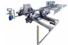
» LÍNEAS DE SOLDAR Y LIMPIAR
